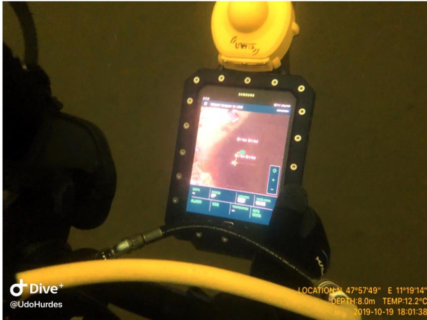
Damit der Taucher seine eigene Position sehen bzw. Nachrichten empfangen kann, benötigt er ein wasserdichtes Notepad, welches sich per Bluetooth mit der UW-Einheit koppelt. Eine Android-App zeigt die Position des Tauchers und ggfs. der anderen Taucher und Drohnen sowie von der Oberfläche an den Taucher übermittelte Kurznachricht an.
