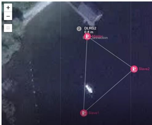
Die drei Bojen kommunizieren über WLAN untereinander, dazu dient eine als „Masterboje“. Diese berechnet aus den Laufzeiten die Position der Unterwassereinheit und leitet sie per WLAN an den Nutzer weiter.
